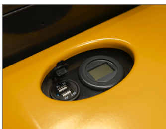
Полноценный ЖК-дисплей с индикацией заряда и состояния, возможность установки USB-порта (опция)
