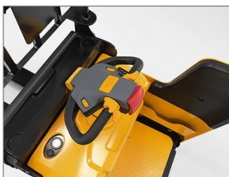
Платформа оператора прорезинена внутри и имеет амортизацию пола
